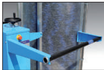
maniglione di guida driving and control handle
