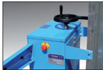
volantino per l'inclinazione tilting steering wheel
