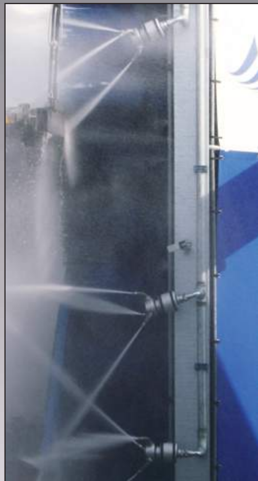
Lavaggio alta pressione con testate rotanti High pressure cleaning with rotating heads
